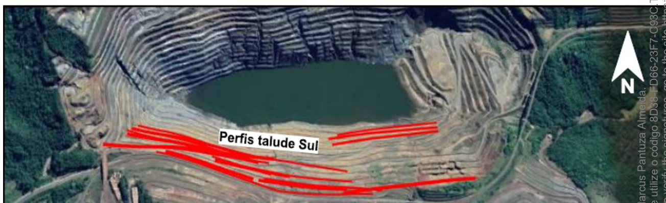
Figura 5-11 – Perfis de Caminhamento elétrico. (Fonte: Planenge, 2019 – documento: “Relatório Técnico, Levantamento Geofísico Aplicado a Estudos Geotécnicos e Hidrogeológicos”)
