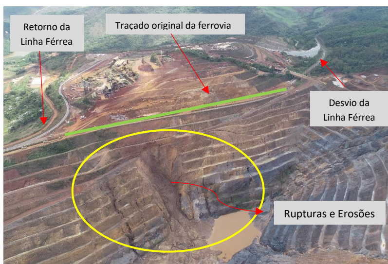
Figura 4- Foto da ruptura do Talude Sul em 2022.
