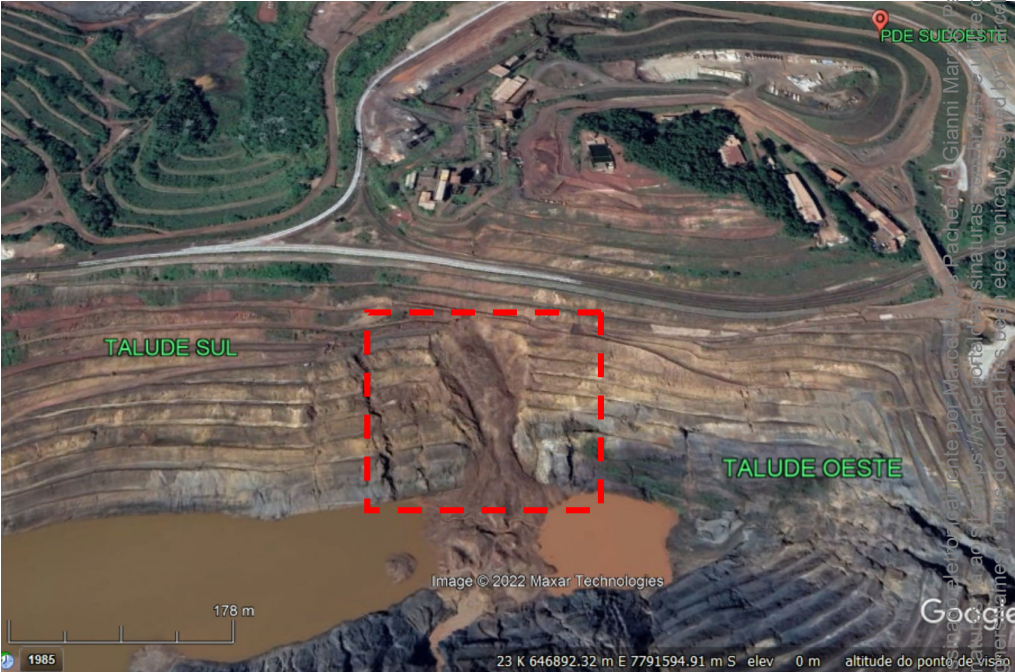
(b) Ruptura Global entre 2021 e 2022 (início da recorrência)
