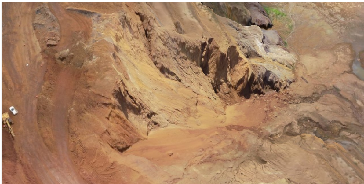
Figura 5-20 - Ruptura do Talude Sul – Vista Superior (Fonte: Propeller)
