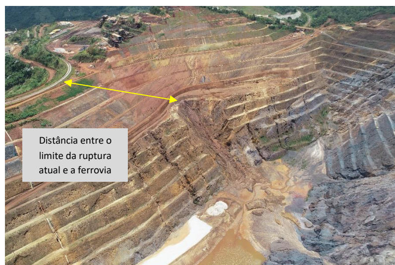
Figura 5 - Foto do avanço da obra e a ruptura do Talude Sul em 2024.
